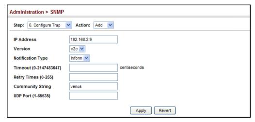
**Figure 237: Configuring Trap Managers** (SNMPv3)
