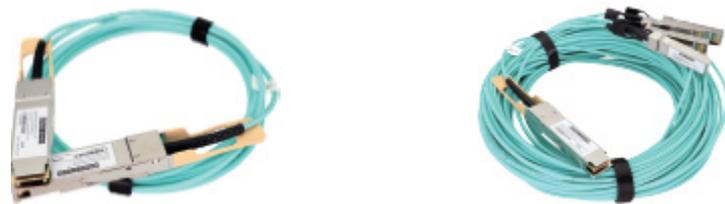
ET7402-DAC-xM 是一种 1~5 m 短无源铜质直连线缆, 带有一个 QSFP28 到 QSFP28 100G 的连接器。ET7402-25DAC-xM 是一种 1-5m 短无源扇出铜质直连线缆, 带有一个 QSFP28 连接器和四个 SFP28 25G 连接器。QSFP28 线缆组件是适用于 100G 以太网和 100G 光纤通道应用的高性能、经济高效的 I/O 解决方案。QSFP28 铜模块允许硬件制造商以极低的成本和更低的功率预算实现高端口密度、可配置性和利用率。高速线缆组件满足并超过千兆以太网和光纤通道行业标准对性能和可靠性的要求。
