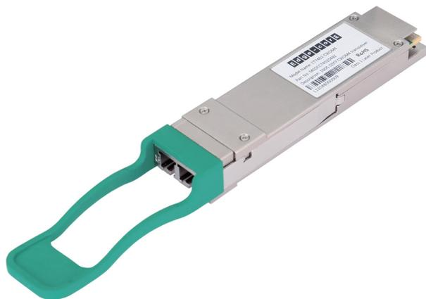
ET7402-CWDM4 收发器模块设计用于单模光纤上的 100 Gigabit 以太网。该收发器与 QSFP28 MSA 和 IEEE 802.3ba 兼容。根据 QSFP28 MSA 的规定, 数字诊断功能可通过 I2C 接口使用。
