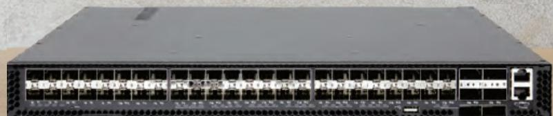
钰登DCS208 交换机满足企业和云数据中心的高性能、可用性和网络扩展要求。DCS208 通过 48 个 10GbE 端口和 6 个 40GbE 上行链路在第 2 层或第 3 层提供全线速交换。该交换机可以部署为架顶式交换机，也可以部署为 10GbE 或 40GbE 分布式主干的一部分，形成无阻塞折叠 CLOS 数据中心架构。该交换机可机架安装在标准 19 英寸机架中，或与 21 英寸开放式机架中的开放式机架交换机适配器一起安装。
