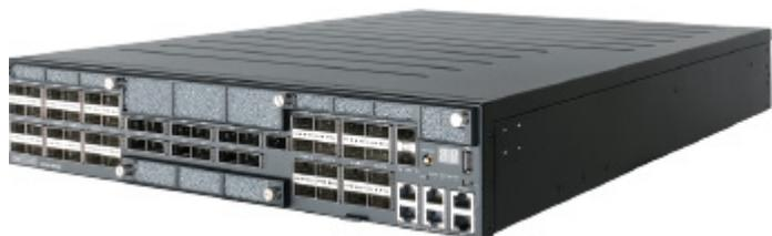
AS7926-40XKFB 是一款高性能 100GbE 分体式路由器, 采用 Broadcom StrataDNX Jericho 芯片设计, 由固定的 40 x 100GE QSFP28 网络接口 (NIF) 和 13 x 400GE QSFP-DD 光纤接口 (FIF) 组成, 采用 2RU 外形。
