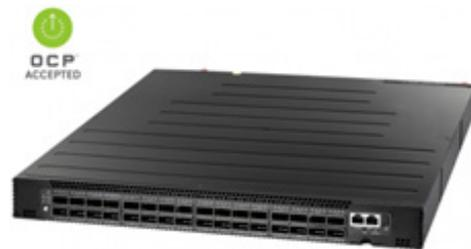
钰登 AS7712-32X 和 AS7716-32X 交换机是高性能数据中心架顶式 (ToR) 或 Spine 交换机。在紧凑的 1RU 外形中, 交换机提供 32 x QSFP28 端口的线速 L2 和 L3 交换, 支持最多 32 x 40/100 GbE, 64 x 50 GbE 或 128 x 10/25 GbE 连接。AS7712-32X 和 AS7716-32X 可部署为 ToR 交换机, 为 10/25/50 GbE 的服务器提供 40/50/100 GbE 上行链路; 或部署为主干交换机, 以提供 40/50/100 GbE 主干互连。这两款开放网络交换机都预装了开放网络安装环境 (ONIE), 该环境支持安装兼容的网络操作系统软件, 包括开源的 Open Network Linux 以及其它商业 NOS 产品。
