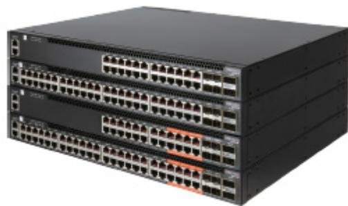
钰登 AS4610系列是高性能的千兆以太网第3层交换机系列，具有30或54个端口。AS4610-30T和AS4610-54T，具有24/48个10/100 / 1000BASE-T端口，4个10G SFP +上行链路端口和2个20G QSFP +堆叠端口（堆叠能力取决于NOS实施）；AS4610-30P和AS4610-54P具有24/48 10/100 / 1000BASE-T端口，4个10G SFP +上行链路端口，2个20G QSFP +堆叠端口以及24/48 10/100 / 1000BASE-T端口完全支持IEEE 802.3at和IEEE 802.3af以太网供电（PoE）。
