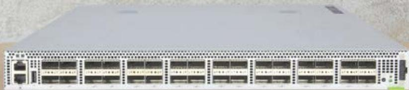
钰登科技 Wedge100BF-32QS 交换机是用于高性能数据中心的架顶式 (TOR) 或主干交换机。该交换机采用 1RU 外形, 可在 32 个 QSFP28 端口上提供线速 L2 和 L3 交换, 支持多达 32 个 40/100 GbE 连接。Wedge100BF-32QS 可以作为支持 25/50 GbE 的 TOR 交换机部署到具有 40/50/100 GbE 上行链路的服务器, 或者作为支持 40/50/100 GbE ToR 和主干互连的主干交换机部署。这款开放式网络交换机加载了开放式网络安装环境 (ONIE), 它支持安装兼容的网络操作系统软件, 包括开源选项 Open Network Linux 和商业 NOS 产品。
