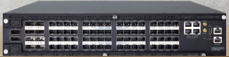
AGR420 是一款高性能 25GbE 聚合路由器，由固定的 64 x 10G/25G SFP28、8 x 100GE QSFP28 和 2 x 100G QSFP-DD (仅支持高功率光纤，也兼容 QSFP28) 具备外部 BCM16K 查找引擎组的网络接口配置。该设备使 2RU 紧凑型设计能够部署为分解或独立路由器。
