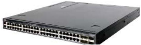
钰登科技 EPS202 是一款高性能千兆以太网 L2/L3 交换机, 具有 54 个端口; EPS202 有 48 个 10/100/1000BASE-T 端口, 4 个 10G/25G SFP28 上行端口, 2 个 100G QSFP28 堆叠端口 (堆叠能力取决于 NOS); 此外, 48 个 10/100/1000BASE-T 端口完全支持 IEEE 802.3at 和 IEEE 802.3bt 以太网供电 (PoE)。
