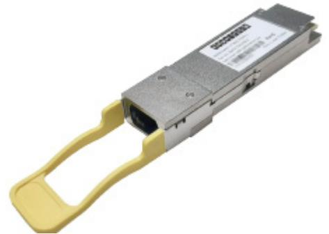
钰登的ET7402-PSM2-2 QSFP28收发器模块设计用于长达2公里的单模光纤的百兆以太网链接。它们符合QSFP28 MSA和IEEE P802.3bm的部分规定。根据QSFP28 MSA的规定，数字诊断功能可通过I2C接口实现。QSFP28全双工光模块提供4个独立的发送和接收频道，每个频道能够以25Gb/s的速度运行，总数据速率为100Gb/s。
