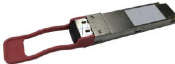
钰登的 ET7402-ER4 QSFP28 收发器模块专为单模光纤上的 100 千兆以太网而设计。它们符合 QSFP28 MSA、100GBASE-ER4 Lite。数字诊断功能可通过 QSFP28 MSA 指定的 I2C 接口获得。该模块符合 RoHS指令。
