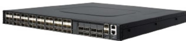
钰登 AS7326-56X交换机是用于高性能数据中心的机架式 (TOR) 交换机。在紧凑的1RU尺寸中, 该交换机可在48个 SFP28 + 8个QSFP28端口上提供线速L2和L3切换, 每个QSFP28端口可配置为2 x 50 GbE, 4 x 25 GbE, 1 x 40 GbE, 或使用DAC分支连接4 x 10 GbE。可以将AS7326-56X用作支持10/25 GbE的TOR交换机, 部署到具有40/50/100 GbE上行链路的服务器上。该开放式网络交换机装有开放式网络安装环境 (ONIE), 该环境支持安装兼容的网络操作系统 (NOS) 软件, 包括开放源代码选项开放式网络Linux以及商业化的NOS产品。
