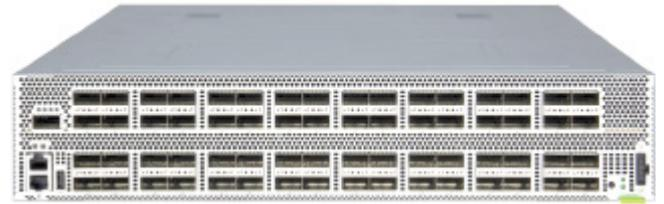
钰登 DCS802交换机是用于高性能数据中心的机架顶 (TOR) 或主干交换机。交换机采用2RU尺寸,可在65个QSFP28端口上提供线速L2和L3交换,最多支持32/65 x 25/40/50/100 GbE连接。DCS802可以作为支持25/50 GbE的TOR交换机部署到具有40/50/100 GbE上行链路的服务器,也可以作为支持40/50/100 GbE主干互连的主干交换机部署。此开放式网络交换机装有开放式网络安装环境 (ONIE),该环境支持兼容网络操作系统软件的安装。
