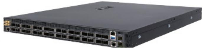
钰登DCS510是用于高性能数据中心的主干交换机。交换机通过32个QSFP56-DD端口提供线速L2和L3交换，每个端口支持1 x 400 GbE或1 x 100 GbE，或者通过4 x 100 GbE或4 x 25 GbE分支线缆。DCS510可以作为支持100/400 GbE骨干互连的主干交换机部署。此开放式网络交换机装有开放式网络安装环境 (ONIE)，该环境支持安装兼容的网络操作系统软件，包括开放源代码选项“开放网络Linux”以及商业NOS产品。
